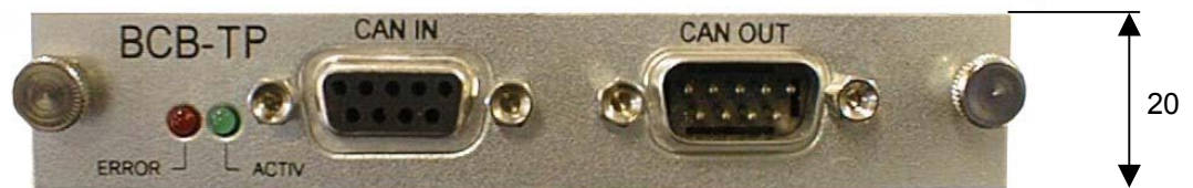
Frontplatte des BCB-TP, mit Sicht auf die Anzeigen und die Anschlüsse.
